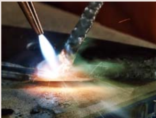
Div. Hartauftragungslote auf Wolframcarbid Basis ! Extrem hohe Verschleissfestigkeiten !
